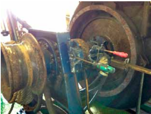
Figura 2. Maquinilla. Órganos de accionamiento improvisados
