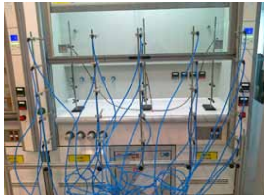
Figura 12b. Entramado de sondas de muestreo en el plano externo de la guillotina
