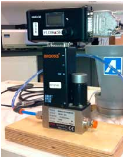
Figura 2. Regulador del gas de ensayo
