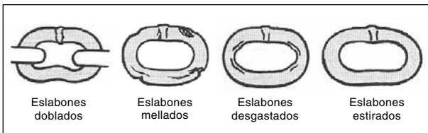
Figura 20. Tipos de desperfectos en eslabones
